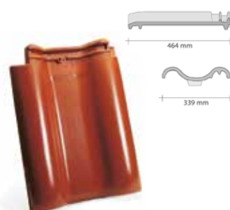
taška s dvojitou návalkou - krycí délka cca: 38,3–40,3 cm - krycí šířka cca: 33,9 cm - hmotnost 1 ks cca: 3,5 kg - používá se jako estetické zakončení levého okraje plochy střechy, namísto základních tašek u kterých by byl vidět zámek. Např. v místě kde střešní plocha navazuje na vyšší stěnu štítu vedlejšího domu
