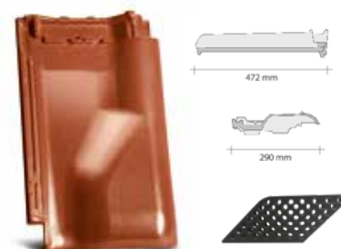
větrací taška - větrací průměr cca: 23 cm 2 - min. požadavek na odvětrání u hřebene je 50 cm 2 /bm - hmotnost 1 ks cca: 4,5 kg Obvykle se větrací tašky pokládají do 2 řad pod hřebenem. Součástí tašky je mřížka do otvoru proti škůdcům.
