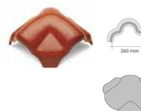
rozbočovací hřebenáč univerzální Y, dostupný je i ve tvaru X nebo T - hmotnost 1 ks cca: 4,8 kg
